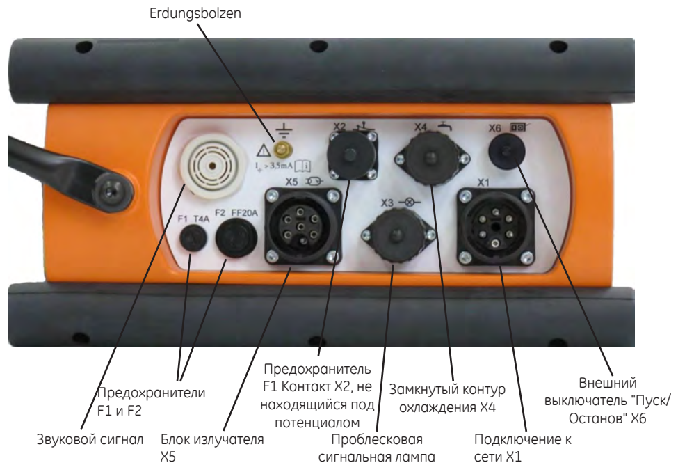
Рис. 5 - Утопленная панель штекерных разъемов прибора цифрового управления ERESKO MF4 (показано без кожуха и ручки)
