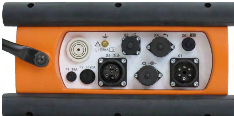
Рис. 7 - Утопленная панель штекерных разъемов прибора цифрового управления ERESKO MF4
